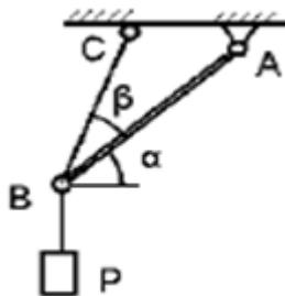
2. Груз весом  $P = 10 \text{ Н}$  подвешен на двух тросах АВ и ВС, составляющих с горизонтальной прямой углы  $\beta=15^\circ$  и  $\nu=30^\circ$ . Определить усилия в тросах.
